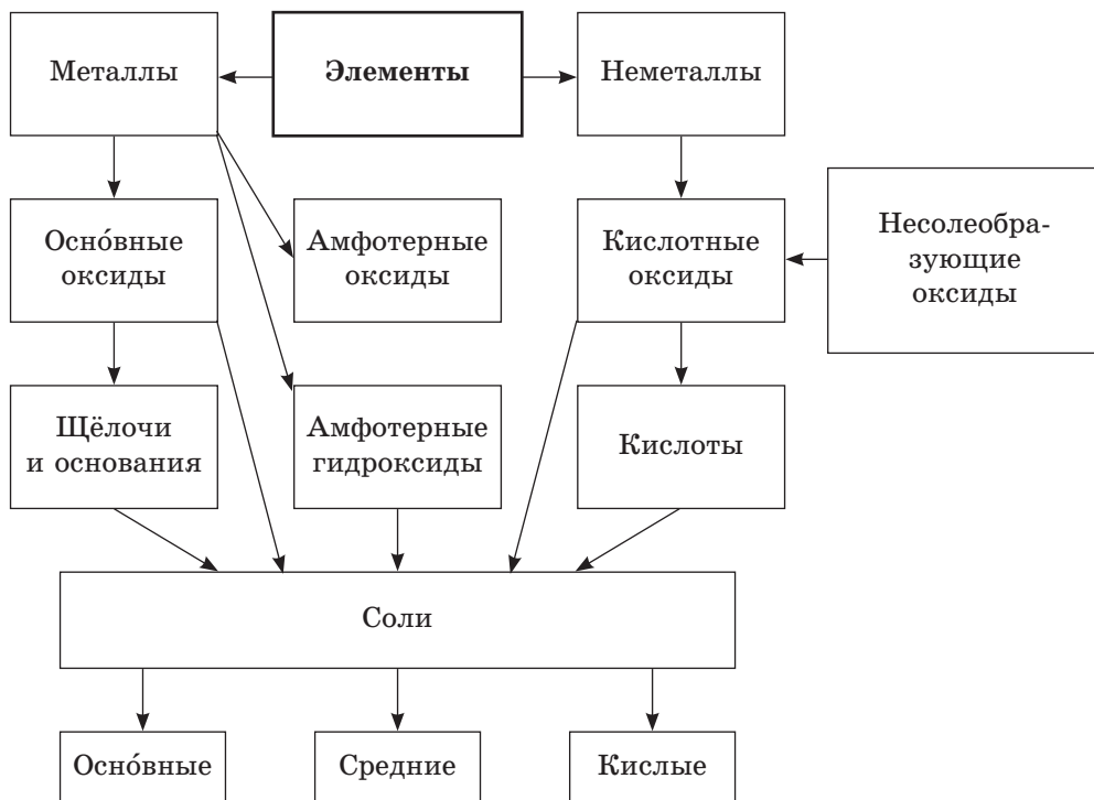
Схема 6. Генетическая связь между основными классами неорганических соединений
